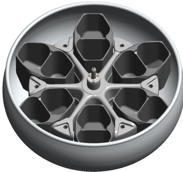
Afbeelding III-8: Bekere in rotor plaatsen, voorbeeld HAEMAFlex 12
