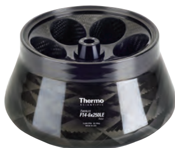
Fiberlite F14-6x250 LE Fixed Angle Rotor, 23°, R_{\max} 137 mm
